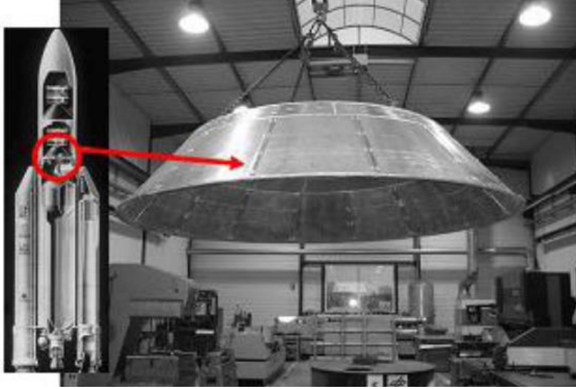
Şekil 10. Sandviç köpük panelden (AFS) yapılmış Ariane5 roket konisi [1].
