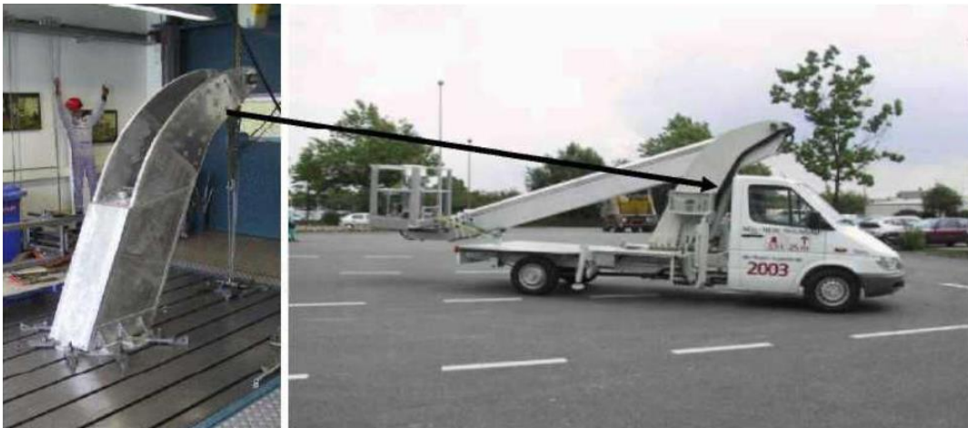
Şekil 5. Alüminyum hafif-ağırlıklı sandviç panel örneği [1].
