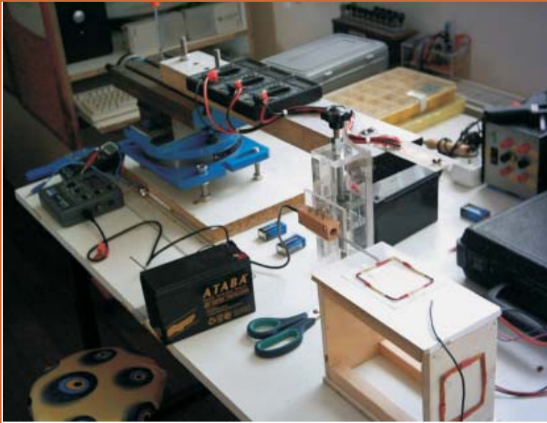
Şekil 2. Şekil 2 : Dikdörtgen Geometrideki Bir Sargıda Oluşan Manyetik Alanın Büyüklüğünü Ölçmek İçin Kurulan Sistemin Genel Görünümü. Manyetik Alan Ölçümü Sypris ElfMeter DC Gaussmetre ve Lineer Probu ile Yapılmaktadır. Prob Pozisyonu x,y,z Eksenleri Boyunca 0.1mm den az Hassasiyetle Sağlanabilmektedir.
