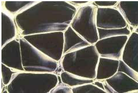
Şekil 1- Açık ve Kapalı Hücre Yapısı
