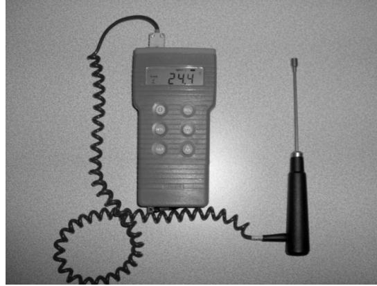
Şekil 3. Ense Bölgesi Deri Sıcaklığı Ölçümünde Kullanılan Termometre ve Yüzey Sıcaklığı Ölçüm Probu
