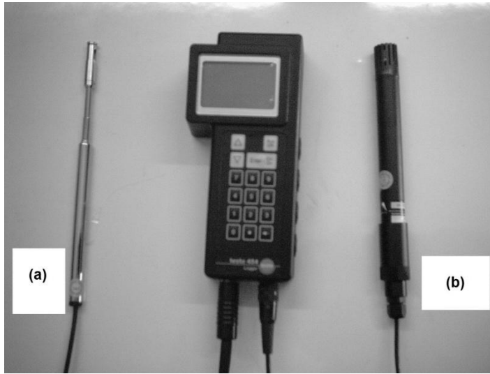
Şekil 2. Testo 454 Veri Toplama Cihazı (a) Hava Hızı Ölçüm Probu (b) Ortam Sıcaklığı Ve Bağıl Nem Ölçüm Probu
