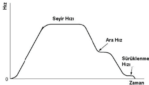
Şekil 1. Asansörde hız zaman eğrisi
