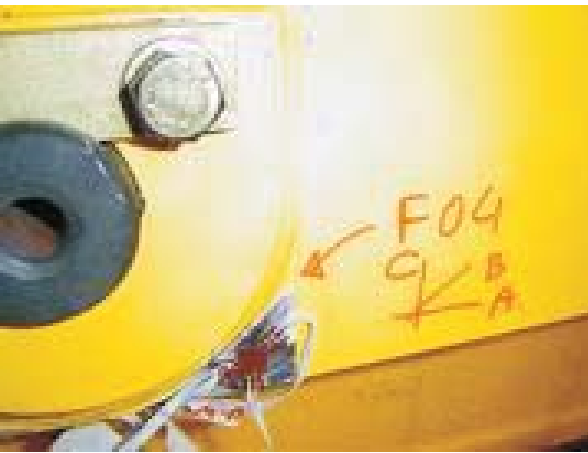
Şekil 14. Strain Gage Rozetlerinin Yapıştırıldığı Değişik Kritik Konumlardan Örnekler
