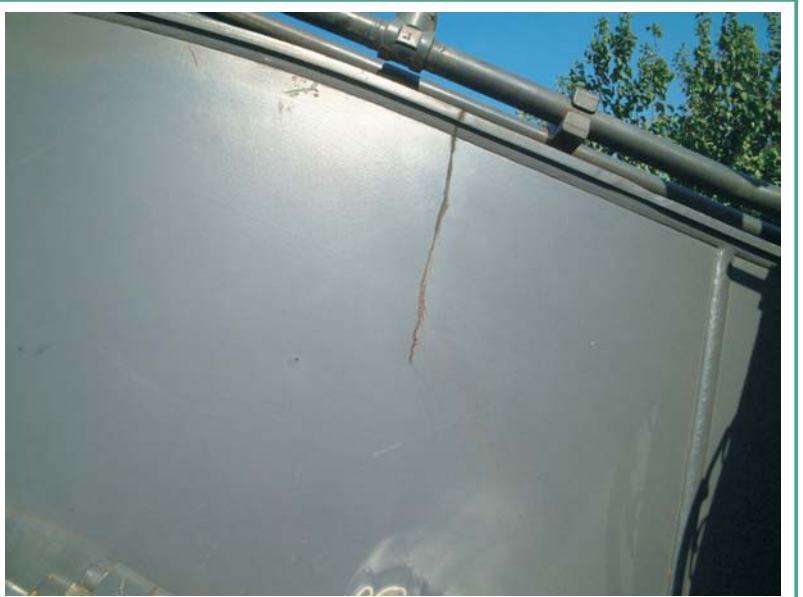
Şekil 5. Ekskavatör Bomunun Makina Gövdesine Bağlandığı Bölgeye Yakın, Üst ve Yan Saclarda Oluşan Devamlı Çatlağın Sağ Taraftan Görünüşü
