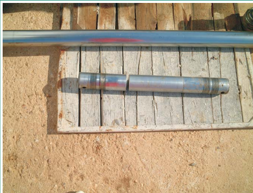
Şekil 7. Malzeme Yorulması Sonucu Kıran Hidrolik Silindirin Bağlandığı Yatak Pimi
