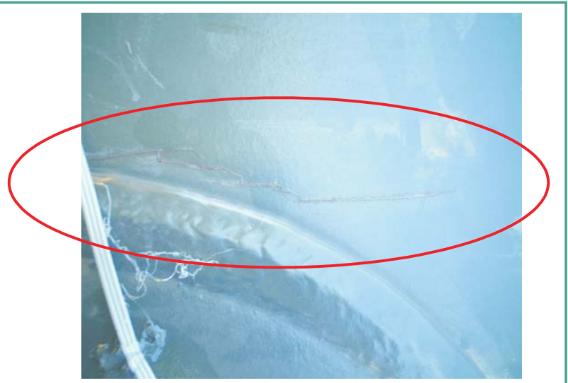
Şekil 4. Paletli Bir Ekskavatörün Bomunun Orta Göbek Yatağının Çevresi Boyunca Oluşan Yırtılma
