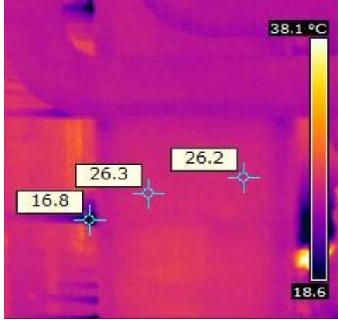
Şekil 18. Termal kamera ile soğutma sisteminde enerji tasarrufu için soğuk izolasyon yapılan ısı eşanjörünün kontrolü
