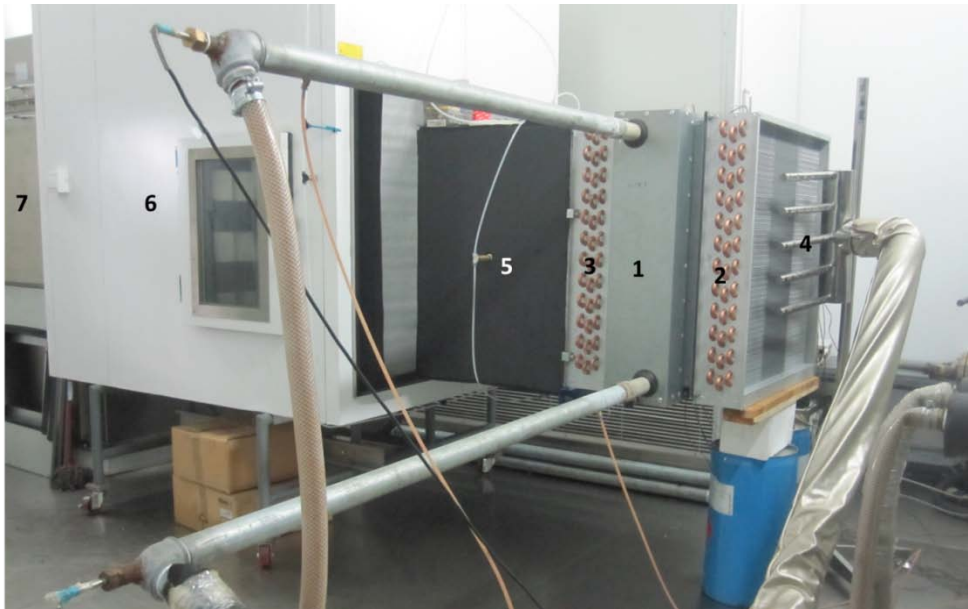
Şekil 21. Test Düzeneği (1. Soğutucu Batarya, 2. IBID Buharlaştırıcı Bölgesi, 3. IBID Yoğunlaştırıcı Bölgesi, 4. Hava Numune Alma Cihazı 5. Kanal Bağlantısı, 6. Hava Alıcı Oda, 7. Hava Debisi Ölçüm Odası)
