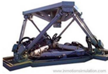
Şekil 1. 6 Serbestlik Derecesine Sahip Bir Hareket Taklitçisi [6].
