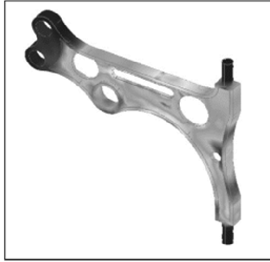
Şekil 4. Topoloji Optimizasyonu Sonucu Malzeme Dağılımı
