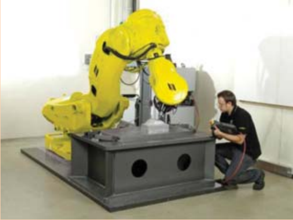
Resim 2: Çok Boyutlu Sürtünme Karıştırma Kaynağının, Uzaktan Kontrol Kumandası ile Çalıştırılması.
