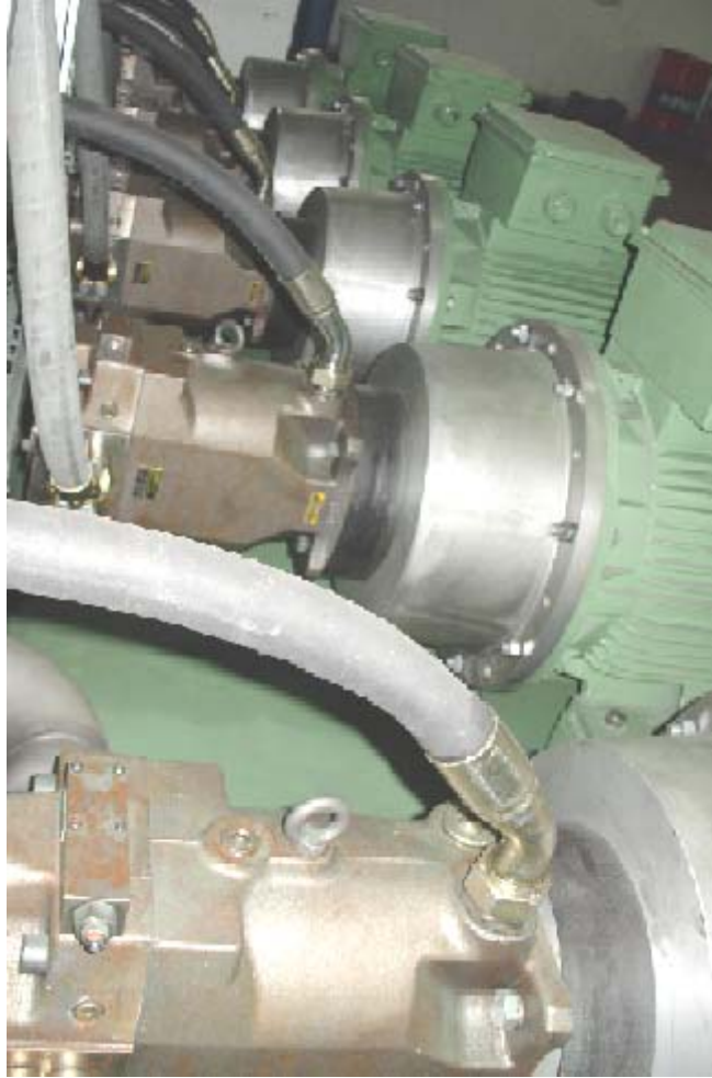
Şekil 11. Çoklu pompa kullanımına örnek.
