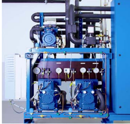
Şekil 8. Subkritik ve Transkritik Kompresörler ile Küçük Güçlendirici Sistemi
