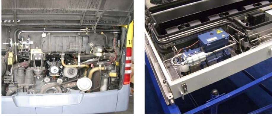
Şekil 4. Otobüs Kliması İçin Bir Açık Tip Taşıt Uygulaması Ve Demiryolu Kliması İçin Bir Yarı-Hermetik CO 2 Kompresör Konvekta (2009)
