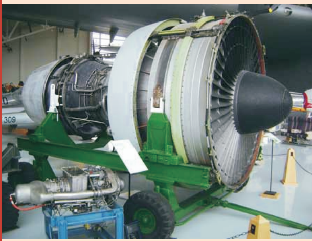
Oregon McMinnville'deki Evergreen Havacılık ve Uzay Müzesi tepki kuvveti şasisine sahip JT9D motorunu sergilemektedir. Motor, Hughes'un Spruce Goose (H-4) adı verilen (sekiz adet P&WA R-4360 4000 hp 28 silindirli radyal piston motorları ile çalıştırılan) deniz uçağının geniş kanadı altında gösterime sunulmaktadır.
