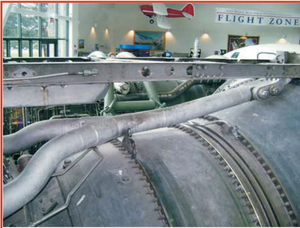
Y şeklindeki tepki kuvveti şasisi Evergreen JT9D motoru üzerine monte edilmiş şekilde gösterilmektedir.
