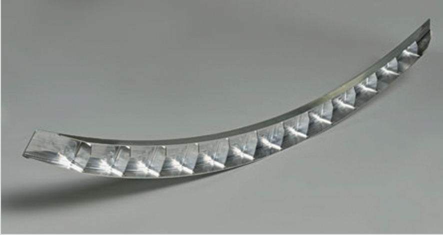
Yeni bir alüminyum-lityum alaşım ailesi kompozitlerle rekabet edebilmek için daha iyi mekanik özellikler ve düşük yoğunluk vaat etmektedir.
