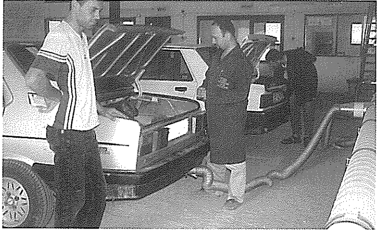
LPG Sızdırmazlık Kontrol Merkezi 'nde aynı anda 5 aracın ölçüm ve kontrolü yapılabiliyor.
