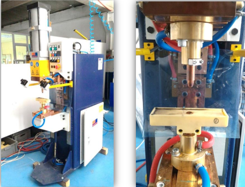
Şekil 5. Deneylerde Kullanılan Mactera Marka Kaynak Makinesi
