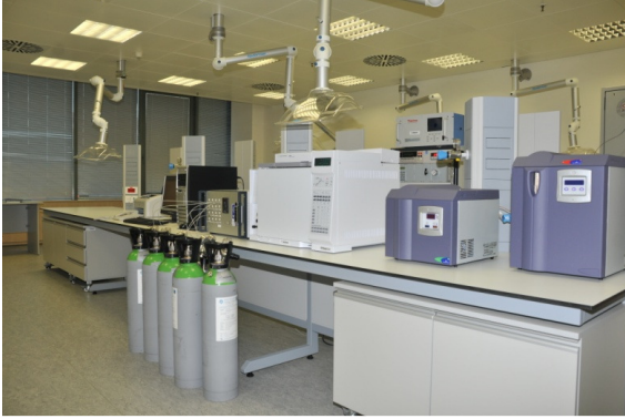
Şekil 5. Gaz analizlerinde kullanılan GC sistemi ve gaz analizörleri
