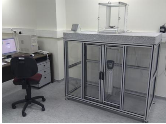
Şekil 2. Özel kabin ve teraziden oluşan tartım sistemi
