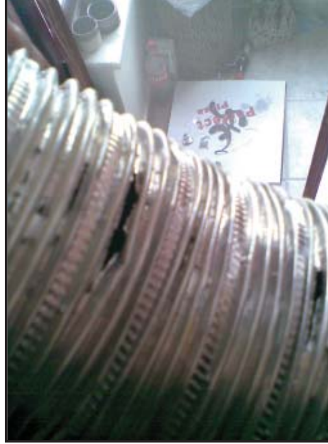
Olay mahalinde çekilen, doğal gaz sızıntısına neden olan bacadaki yırtıkları gösteren fotoğraflar
