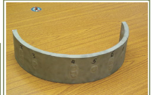
Şekil 8. 718 Plus Alaşımı Kaynak Mekanik Segman Numunesi [15]
