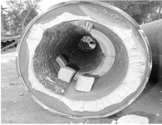
Şekil 2. BD-1' de oluşan kabuk (solda) kuyuya üretim için indirilen 200 mm çapında, 54 m uzunluğunda paslanmaz çelik boru kuyudan çıkartılmış ve 4'er metrelik parçalar halinde kesilerek kabuk kalınlıkları ölçülerek çizilmiştir. Oluşan kabuğun kuyu içindeki geometrisi (sağda) düşey eksen derinlik m., yatay eksen kabuk kalınlığı mm. (ölçeksiz)
