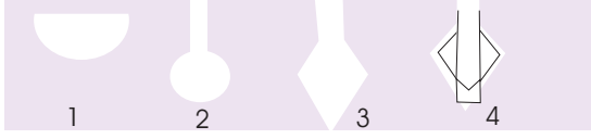
Şekil 1. İnce film kaplama teknolojisi ve BCT tekniği kullanılarak farklı şekillerde üretilen mikrokanaallar [1] yüzeyde yarı dairesel [2] gövdede dairesel [3] gövdede V-olukları [4] yüzeyde V-olukları [13]
