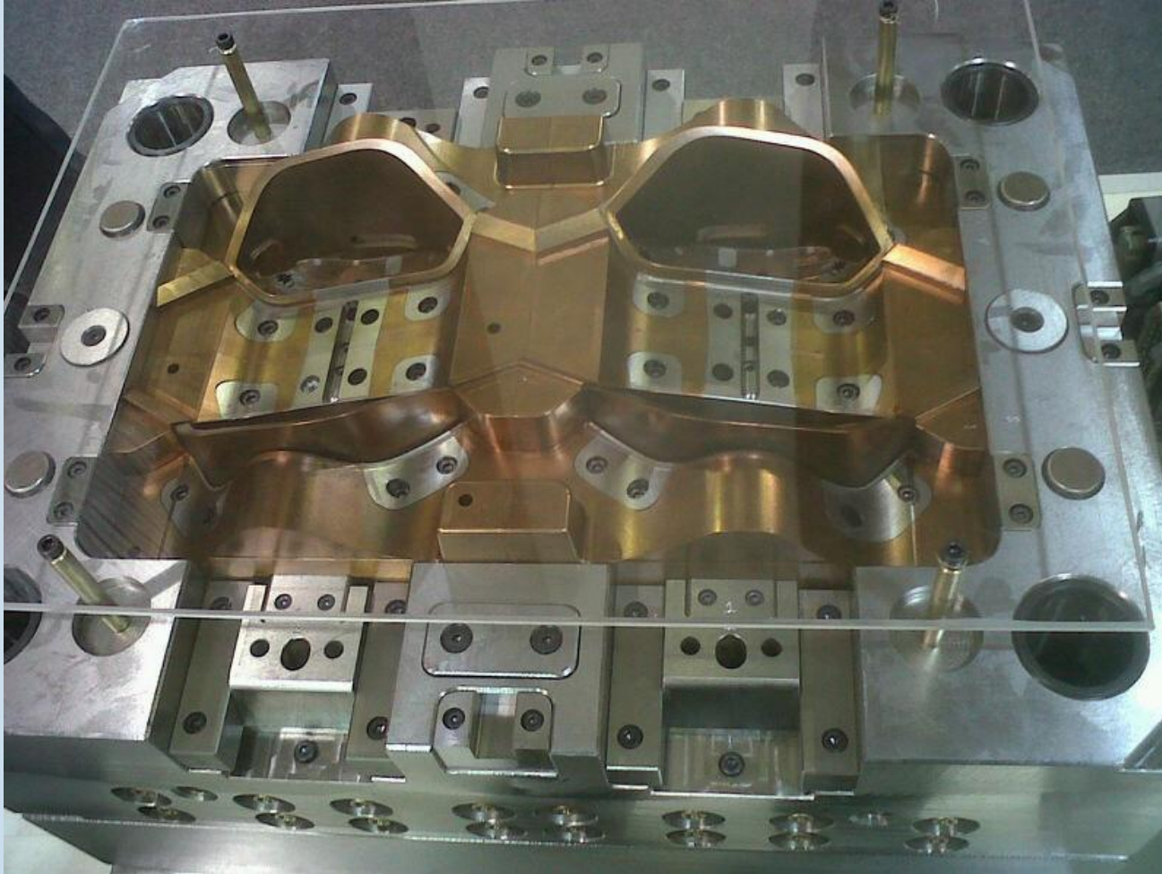
Resim: Arka Stop Sinyal Reflektörü Enj. Kalıbı, Kalıp Aęırlığı: 2 Ton
