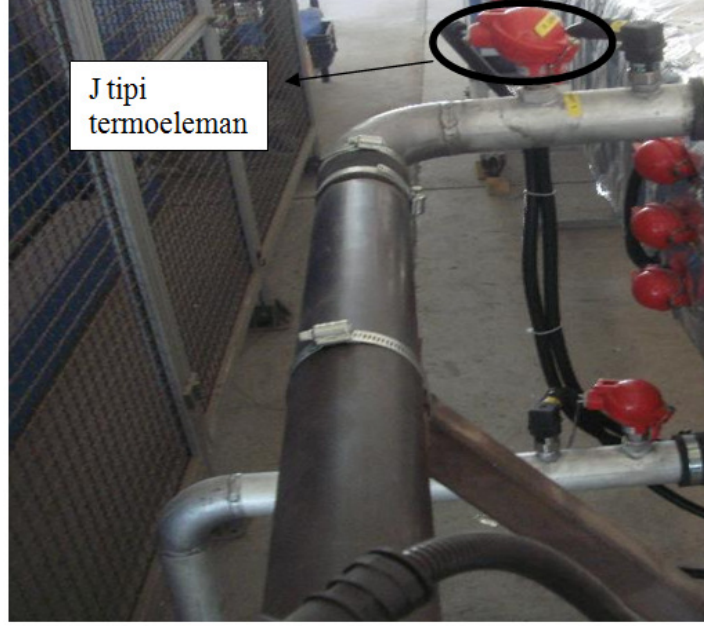
Şekil 4 Deneysel düzeneğinde sıcaklık ölçümü için kullanılan ısı çiftleri
