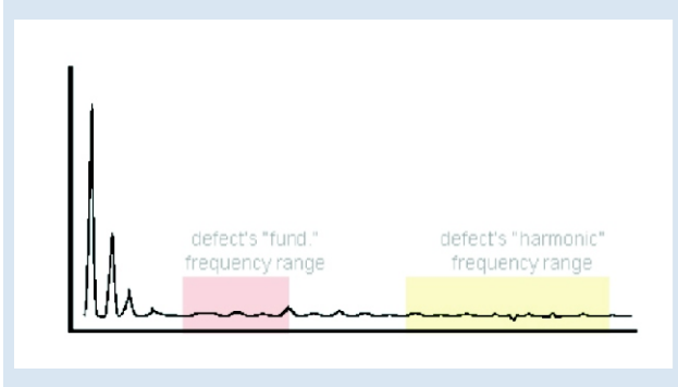
Şekil 11. Rulman Hasarında Birinci Aşama
