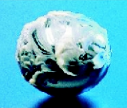
Şekil 5. Rulmanda Yanlış Yağlama Sonucu Oluşan Hasar
