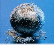
Şekil 4. Rulmanda Kirlenme Sonucu Oluşan Hasar
