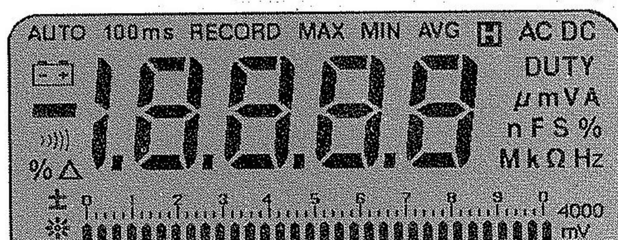
Şekil.2 Fluke/87 RMS Multimetrenin ekran fonksiyonları.
