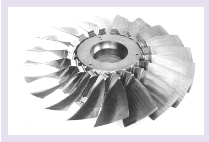
Şekil 7. Doğrusal Sürtünme Kaynağı ile İmal Edilmiş Blisk Örneği [2].
