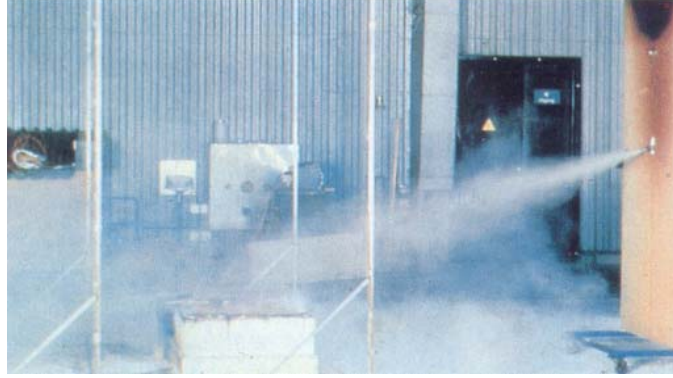
Resim 1.4. HFC Tipi Sıvının 700°C sıcak metal yüzeye püskürtüldüğü an.
