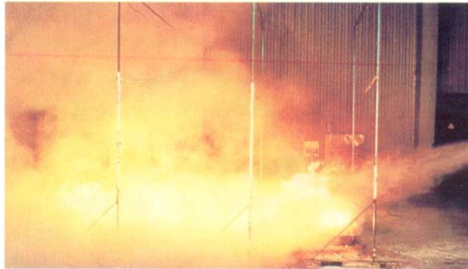
Resim 1.3. Hidrolik Yağ bir sıcak metal yüzeye temas ettiği anda alev alır
