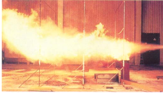
Resim 1.1. Bir delikten püskürtülen hidrolik yağ açık alev ile karşılaştığı anda yanar.
