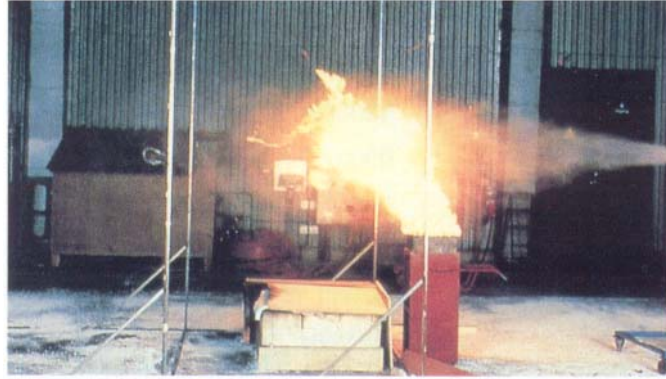
Resim 1.2. Ateşe dayanıklı HFC Tipi Sıvı alevin yönünü etkiler ancak kendisi yanmaz.
