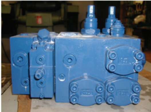
Şekil 4. Korozyon Dayanıklılık Testinden Sonra Bloğun Durumu
