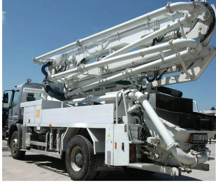
Şekil 13. Kamyona Monte Beton Pompası [4].
