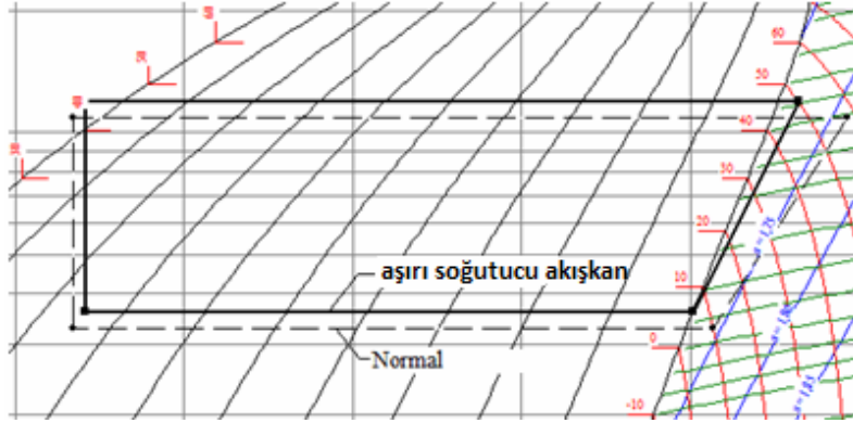
Şekil 11. Aşırı Soğutucu Akışkan Şarjı Durumunda Soğutma Çevrimi
