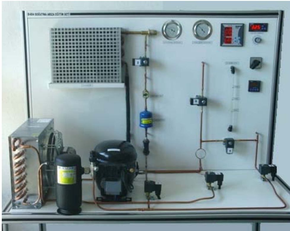
Şekil 5. Soğutma Arıza Bulma Deney Seti [5]
