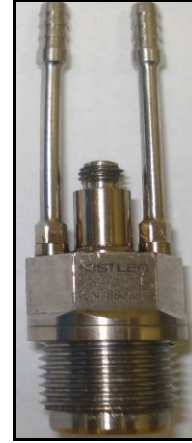
Şekil 2. 25 MPa Piezoelektrik Dinamik Basınç Dönüştürücü
