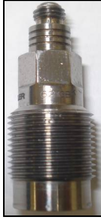
Şekil 1. 800 MPa Piezoelektrik Dinamik Basınç Dönüştürücü
