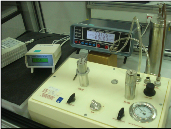
Şekil 6. Sayısal Cihaz Fark Basınç Ölçümlerinde Kullanılan Kalibrasyon Düzeneği
