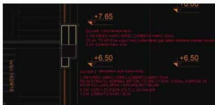
Şekil 1. Isı yalıtımları için detaylı bir mimari proje örneği.
