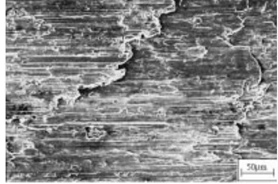
Şekil 14. 1,0 MPa'lık Basınç Altında Deneye Tabi Tutulan Zn-60Al-2Cu Alaşımının Aşınma Yüzeyinin SEM Fotoğrafı
