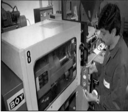
Şekil 8. Yüksek hacimli plastik bileşenler için enjeksiyon kalıbı [1].
