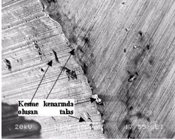
Şekil 6. Kaplamasız Matkapın Delik Delme Sonrası Matkap Kesme Kenarı ve Serbest Yüzeylerinin SEM Mikroskopunda Görüntüsü
