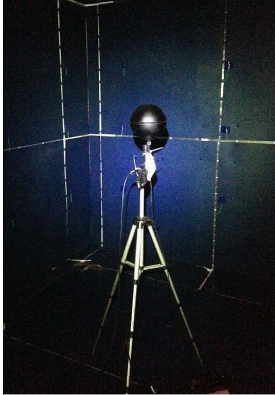
Şekil 7. Siyah küre sıcaklık probu ve sıcak tel anemometresi görünümü
