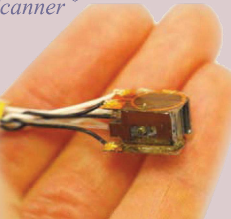
Bu aygıt küçük manyetik alanları ölçmek için lazerle kumandalı rubidyum kullanmaktadır.
