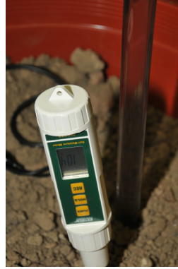
Şekil 5. Dijital toprak nem ölçerle toprak nem ölçümü
