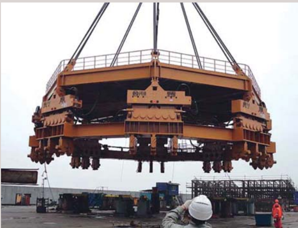
OctaKong dev kazıkları saniyeler içerisinde batırmak için titreşimleri kullanmaktadır.
