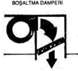
Şekil 16: Damper ile Debi Ayarı
