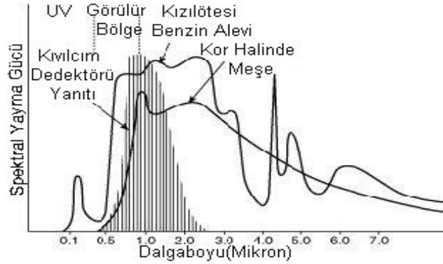
Şekil 2. Kıvılcım dedektörünün spektral duyarlılığı [7]
