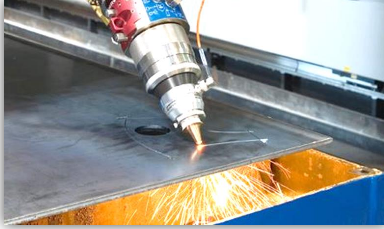
Şekil 1. Beş Eksen Lazer Tezgâhı Örnek Kesim Kafası
