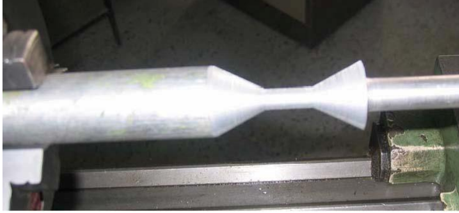
Şekil 14. Silindirik ve konik yüzeylere sahip numune
