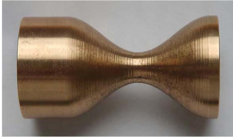
Şekil 15. Silindirik ve eğrisel (sinüzoidal) yüzeylere sahip numune
