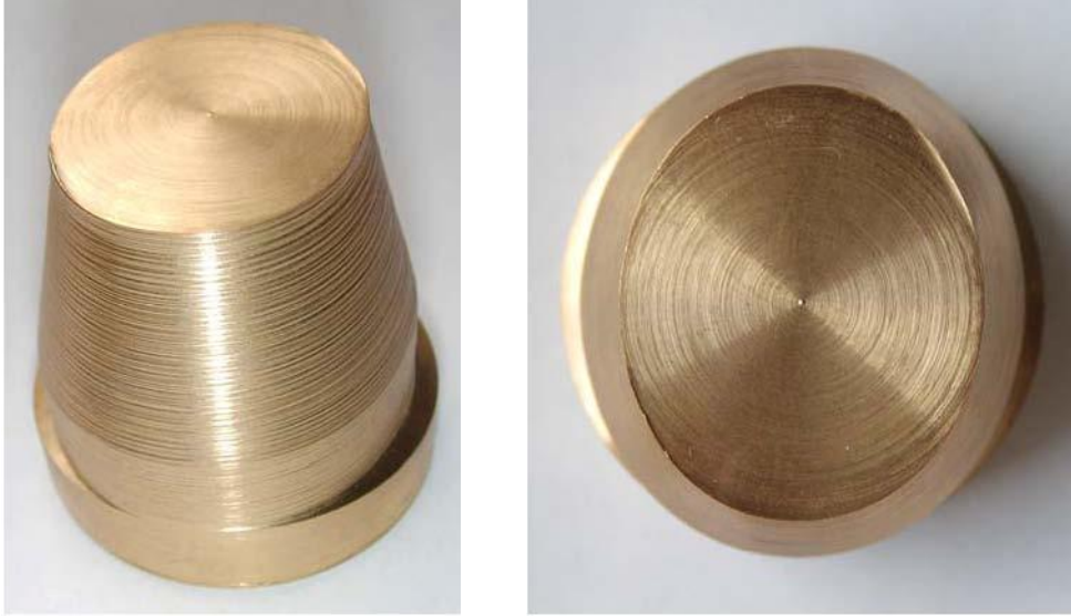
Şekil 16. Silindirik, konik ve oval yüzeylere sahip numune
