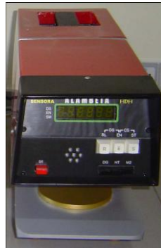
Şekil 1. ALAMBETA Test Cihazı
