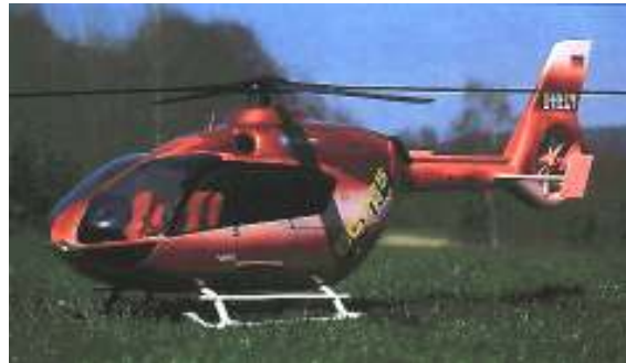
Fenestron anti-tork sistemine sahip bir helikopter
