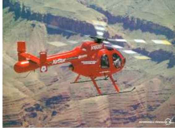
Notar anti-tork sistemine sahip bir helikopter
