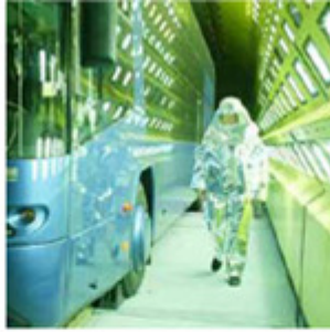
Şekil 3. Güneş Işıması testinin şematik görünümü [1].
