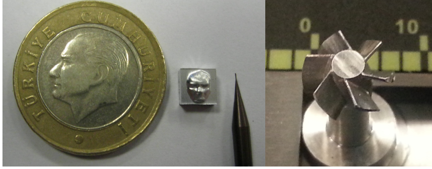
Şekil-2: Mikro frezeleme ile üretilen parçalar
