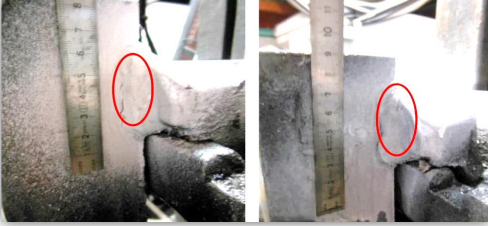
Şekil 7. Forklift Çatalında, Manyetik Parçacık Yöntemiyle Yapılan Kontrol Sonucunda Tespit Edilen Çatlaklar
