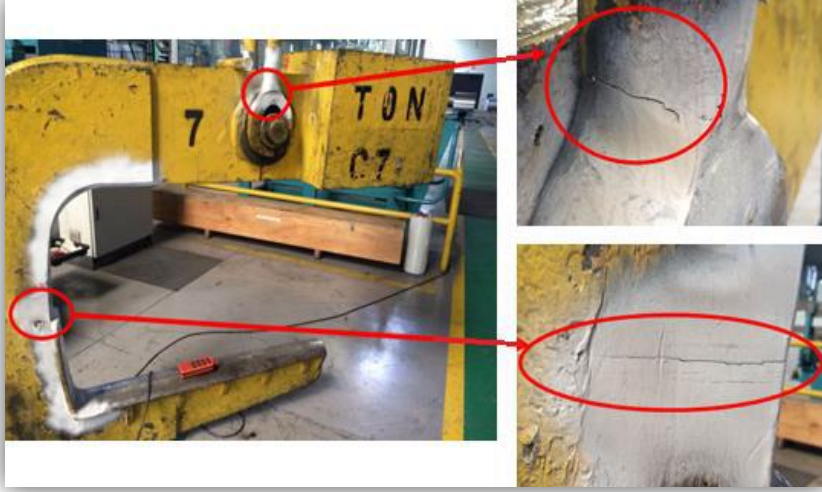
Şekil 8. C kanca Üzerinde, Manyetik Parçacık Yöntemiyle Yapılan Kontrol Sonucunda Tespit Edilen Çatlaklar.
